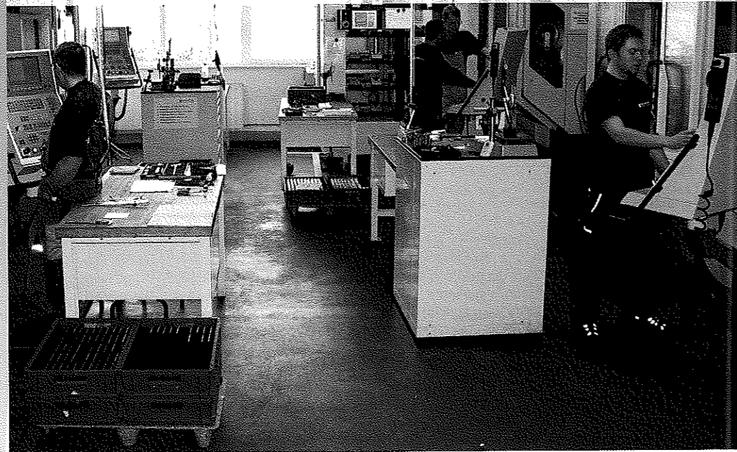
Hermle-Fräszentrum mit den aktuell vier Hermle-CNC-Bearbeitungszentren »C 800 V«, »C 600 U«, »C 30 U« (2x) bei Hein & Oetting Feinwerktechnik GmbH.
